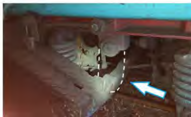
Imaginea 7 - Brida pendulară lipsă de la locomotiva DA 926 (linia albă punctată marchează locul de unde lipsește brida pendulară)
