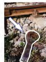
Imaginea 4 - Braț de la brida pendulară, găsit pe terasamentul căii ferate
