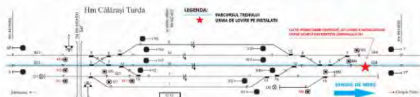
Imaginea 4 – Locul primei urme depistate de lovire a instalațiilor în Hm. Călărași Turda
