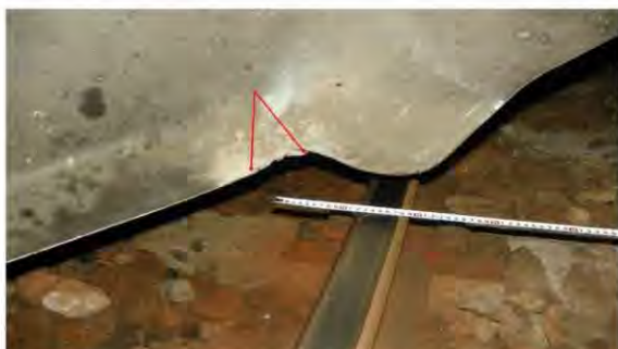
foto 8: distanța aproximativă la care s-a produs lovitura aplicată plugului, față de șina din partea stângă
