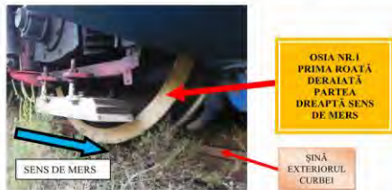
Fotografia nr.1 Roata deraiată (parte dreaptă sens de mers)
