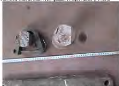
foto nr. 13 – pivotul crapodinei rupt de la boghiul aferent roților 5-8
