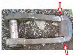
Imaginea 11 – poziția rupturilor pe brațele bridei pendulare de la DA 926 (reconstruire)
