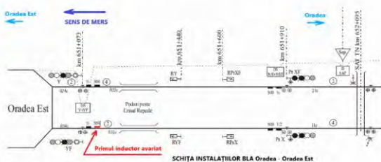
Imaginea 3 - Amplasamentul primului inductor avariat, în raport cu sensul de mers, la semnalul de intrare al stației Oradea Est
