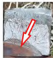
Imaginea 12 – fisură veche în secțiunea de rupere a bridei pendulare
