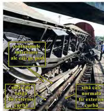
foto nr. 8 - vagonul al doilea deraiat și înclinat înspre interiorul curbei
