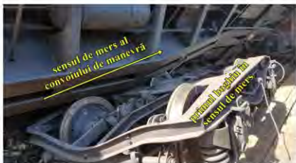
foto nr. 3 - vagonul al doilea deraiat și înclinat deraiat
