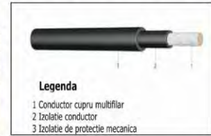
Fig. 14 Schiță structură cablaj forță
