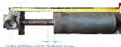
Imaginea 7 – Amortizorul hidraulic vertical după demontare. Se evidențiază cursa tijeii pistonului, de numai cca. 20 mm (zona lăcușoa a tijeii pistonului), față de cei 75 mm – prevăzuți în specificațiile tehnice de specialitate.
