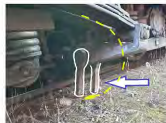
Imaginea 13 – Brațele rupte ale bridei pendulare, s-au rotit înspre terasament (reconstruire)
